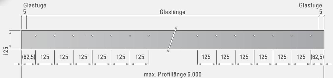
Sonderbohrungen auf Anfrage! Profil- und Glasstoß können unabhängig voneinander ausgeführt werden!
